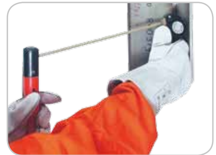
Die schnurlosen Fernregler R11-T können durch einfaches Berühren der Elektrode verwendet werden
