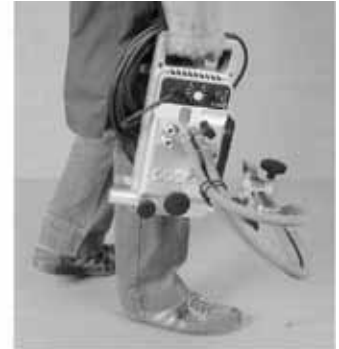
ProFIT ist aufgrund eines Leichtmetallgehäuses bequem tragbar
