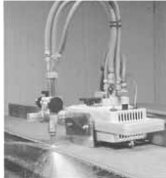
ProFIT für automatische Geradeschnitte durch Winkelprofilführung
