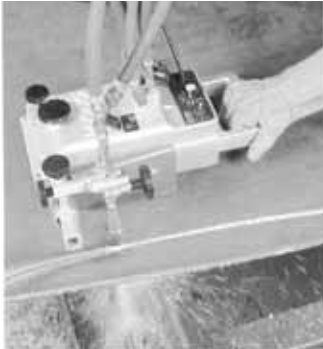
ProFIT für beliebige Konturenschnitte durch Handführung
