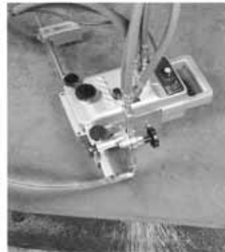
ProFIT mit einseitig angeordneten Brennern für Schweißkantenschnitte
