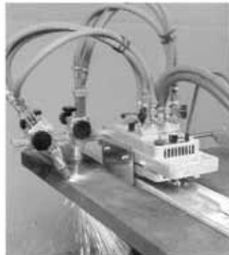
ProFIT mit Kreisschneideinrichtung für automatische Kreisschnitte
