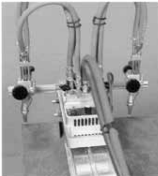
ProFIT mit beidseitig angeordneten Brennern für Streifenschnitte
